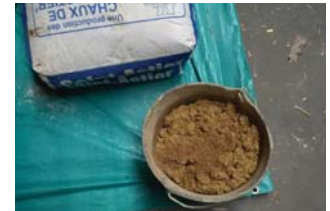
Enduit à la chaux
